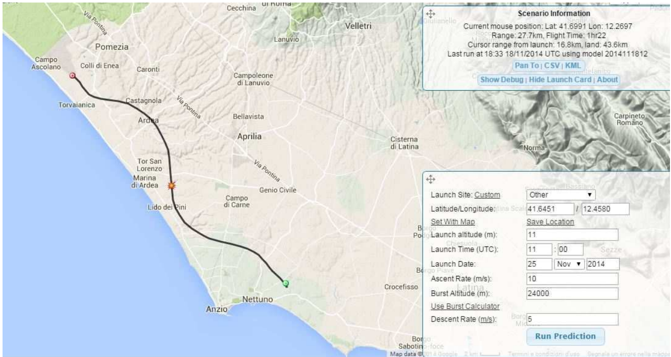
Figura 2: previsione di profilo orizzontale di traiettoria, con informazioni sullo scenario, coordinate geografiche, data e ora del lancio, velocità di salita, quota di scoppio, velocità di discesa.
