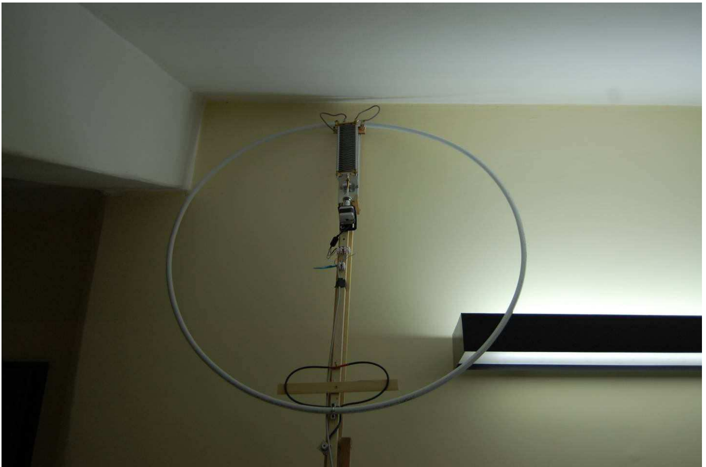
Figura 1 – Prototipo di antenna Loop magnetica con tubo da 16mm in multistrato di alluminio
