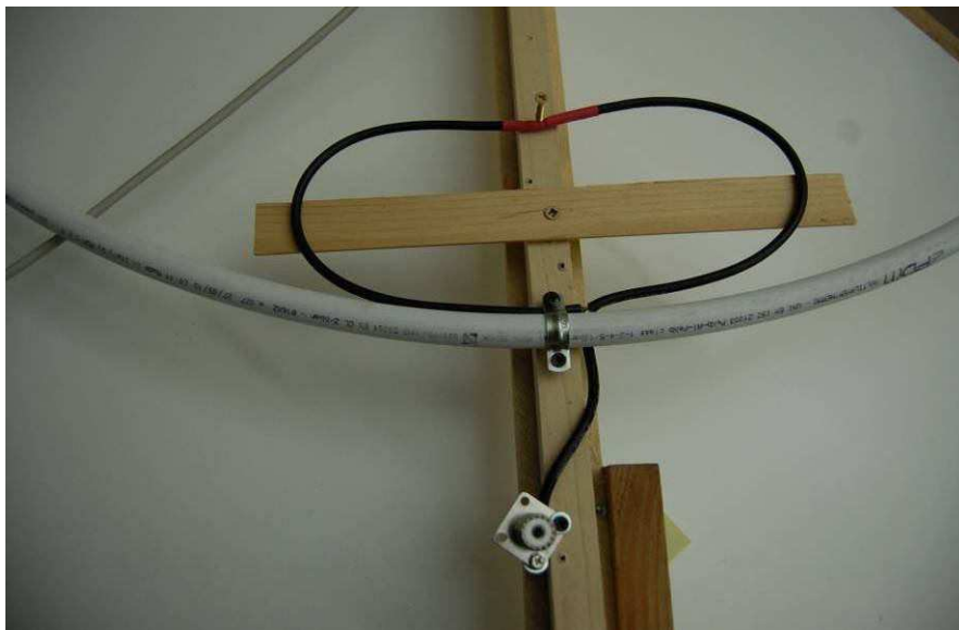
Figura 6 - Accoppiamento con mini loop di tipo capacitivo.
