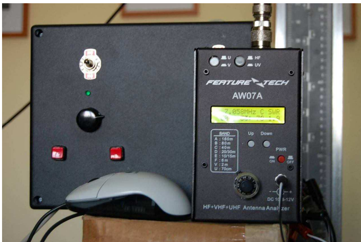
Figura 4 - Controllo elettronico di sintonia con il mouse e il mio misuratore d'antenna
